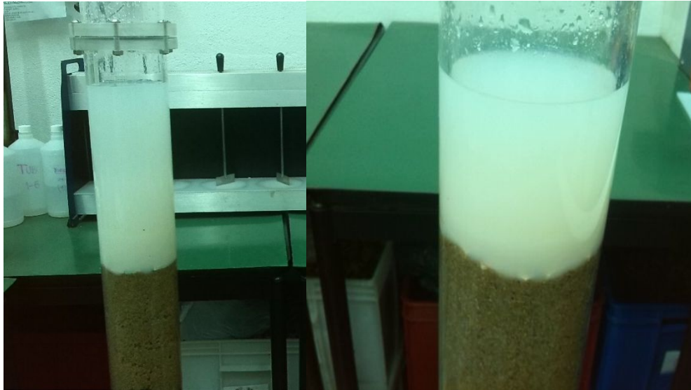
FIGURA 53: Día 9—REACTOR A Y B RESPECTIVAMENTE (ETAPA DE CARGA) — EN AMBOS REACTORES APARECE SOBRENADANTE LUEGO DE LA CARGA, SIENDO MAYOR EN EL REACTOR A
