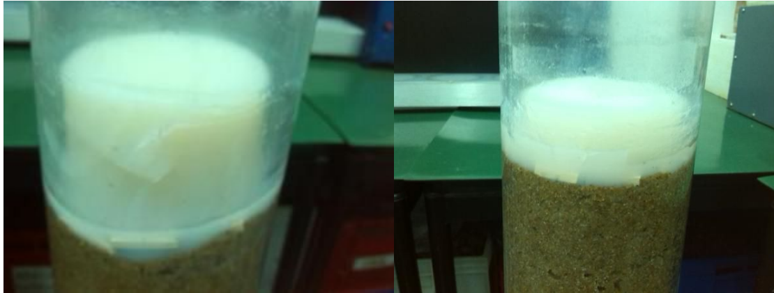
FIGURA 59: DÍA 18– REACTOR A Y REACTOR B RESPECTIVAMENTE (ETAPA DE SECADO). EN AMBOS REACTORES SE FORMÓ LA TORTA DE BARRO, PERO SE APRECIA UN ESPESOR MAYOR EN EL REACTOR A.
