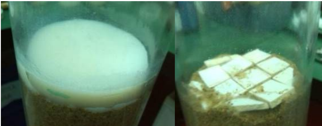
FIGURA 45: DÍA 7 DE CARGA: EL REACTOR A PRESENTA BARRO SOBRE LA SUPERFICIE, MIENTRAS QUE EN EL REACTOR B AÚN NO SE HA FORMADO LA TORTA DE BARRO
