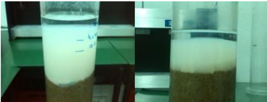
FIGURA 58: DÍA 9—REACTOR A Y REACTOR B RESPECTIVAMENTE (ETAPA DE CARGA). SE OBSERVA MAYOR CANTIDAD DE BARRO Y SOBRENADANTE EN LA COLUMNA A
