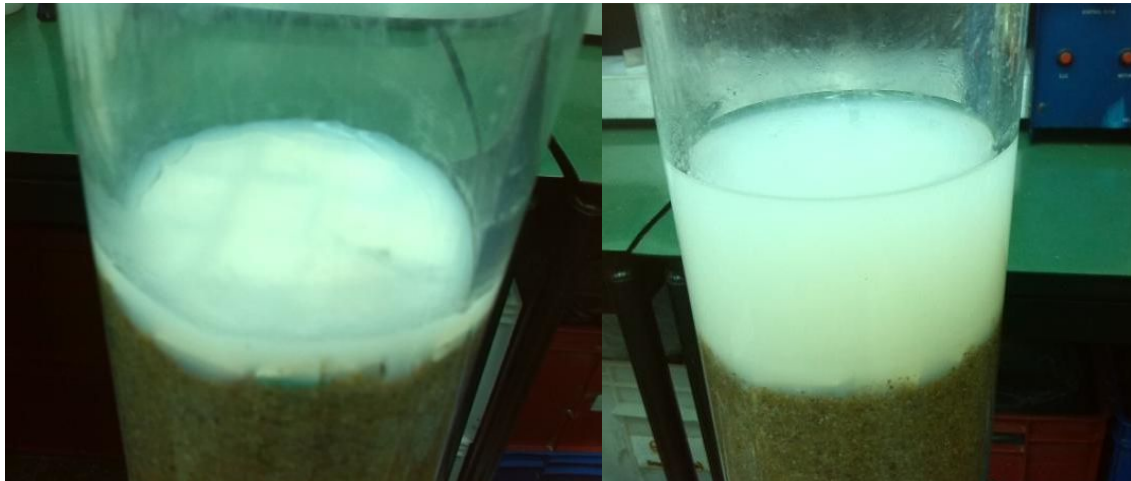
FIGURA 49: REACTOR A Y B RESPECTIVAMENTE DURANTE EL 4TO DÍA DE ENSAYO. SE FORMA UNA PEQUEÑA CAPA DE BARRO EN EL REACTOR A MIENTAS QUE EN EL B LUEGO DE 24 HS. DE REALIZADA LA CARGA AÚN PRESENTA SOBRENADANTE
