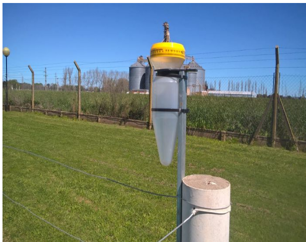
FIGURA 64: PLUVIÓMETRO INSTALADO EN LAS INMEDIACIONES DE LA PLANTA.
