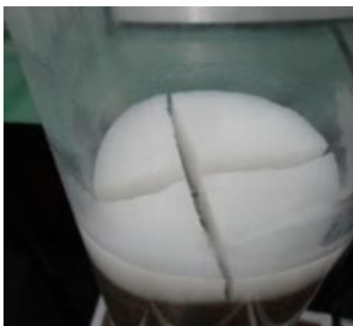
FIGURA 42: BARRO EN REACTOR A, LUEGO DE 72 HS DE PERMANENCIA
