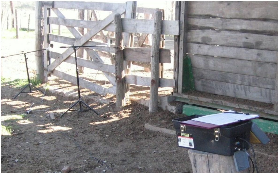
Figura 5. Medición de temperamento. Equipo de velocidad de fuga (FS) con los sensores instalados a la salida de la balanza separados entre sí a 1,90 m. A la derecha se observa el cronómetro con la batería incorporada donde se iban almacenando automáticamente los datos de cada animal. Por encima de la caja la planilla de campo de ese día donde se anotaba también el valor de cada animal que a medida que iba saliendo.
