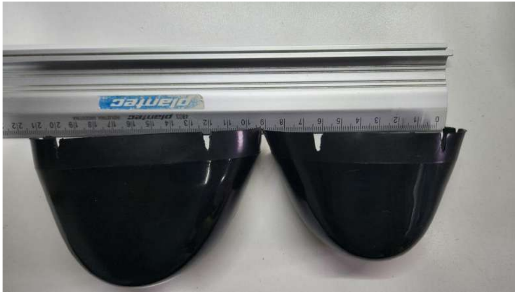
Figura 4 - 11: Diferencias geométricas entre punteras de talles distintos
