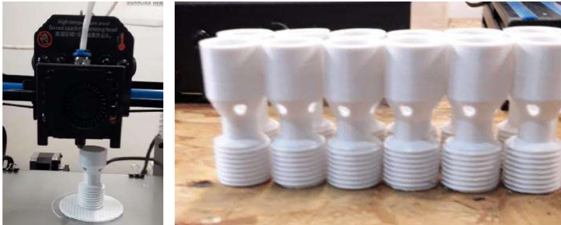
Figura 4-13: Impresión 3D de toberas de inyección
