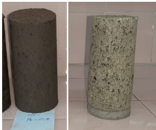
Figura 8.5. Probetas de SAE antes (izq.) y después del curado (der) impuesto por el TG-2 [23].
