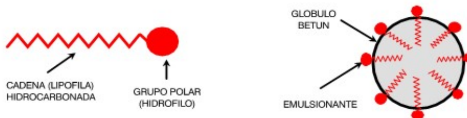
Figura 3.1. Molécula de emulsificante (izda.) y glóbulo de asfalto emulsificado (dcha.) [3]
