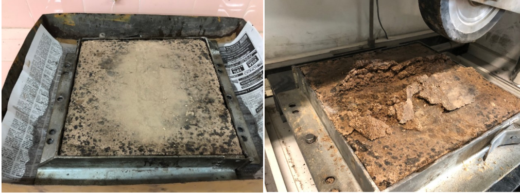
Figura 8.22. Probeta de SAE sometida al Ensayo de Capilaridad (izq.) y al Ensayo de Rueda Cargada luego (der.)
