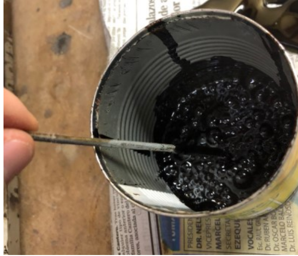
Figura 6.2. Preparación de asfalto espumado en el Laboratorio Vial del IMAE
