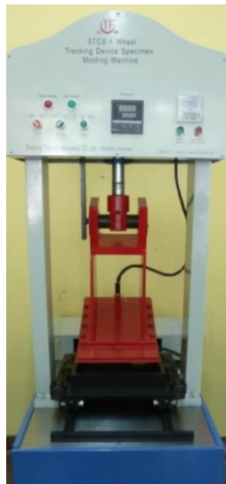
Figura 8.19. Compactación de probeta de SAE, para ensayo WTT.
