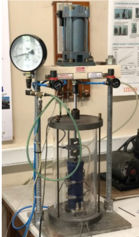
Figura 4.5. Ensayo triaxial dinámico para medida del módulo resiliente en suelos y materiales granulares
