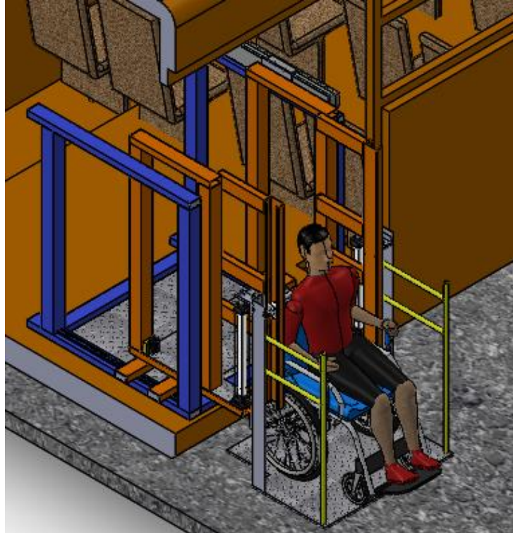
Figura 8-4 Plataforma al nivel del suelo
