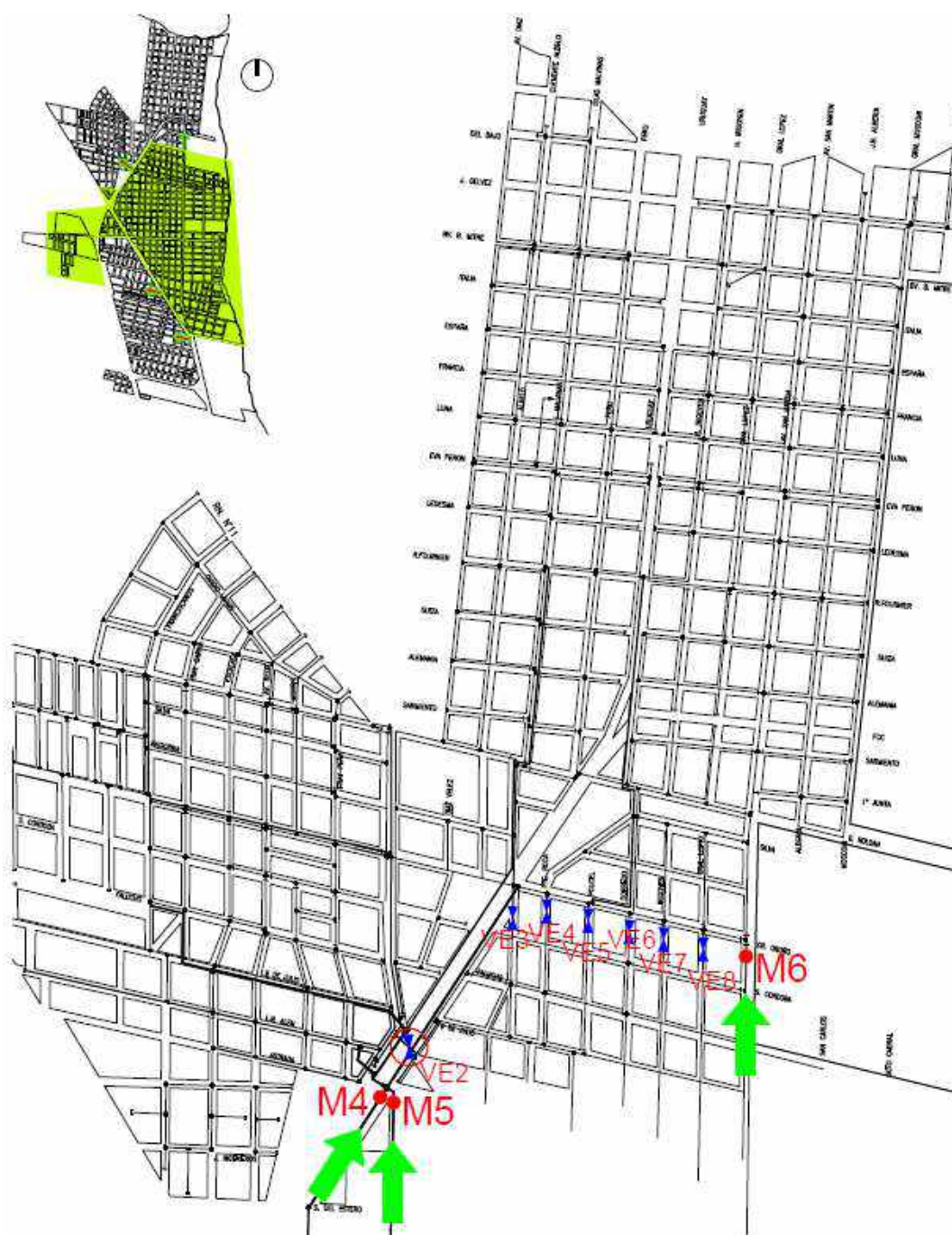
Figura n° 39: Sector n° 2 de aislamiento con los ingresos de agua al sistema cerrado.
