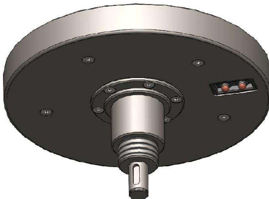
Figura 74: Eje montado en el electroimán.
