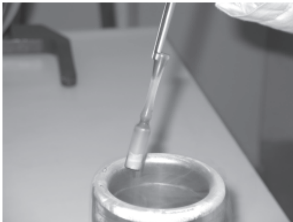
Fig. 2: congelamiento del extracto lipídico en N_2 Líquido por inmersión en vaso de Dewar. Se recomienda extrema precaución en el manejo del N_2 líquido.
