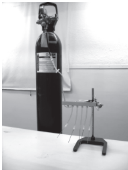
Fig. 1: manifold conectado a cilindro de N_2 , pueden observarse 5 agujas para evaporación de solventes por arrastre conectados al manifold.
