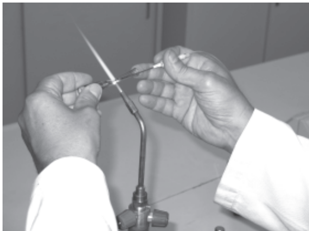
Fig. 3: calentamiento del cuello de la ampolla fluyendo el N_2 para desalojar el aire del interior de la ampolla. Apenas se enrojece el vidrio retirar rápidamente la aguja que aporta el N_2 .
