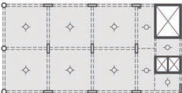
Planta Estructura Residencia Estudiantil sobre 5° piso. Esc. 1:500
