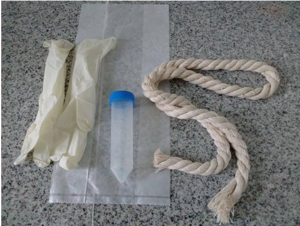
Imagen 2. Guantes descartables, bolsa de polietileno, tubo de centrifuga plástico estéril con tapa a rosca (tipo Falcon) y cuerda de algodón neutro.
