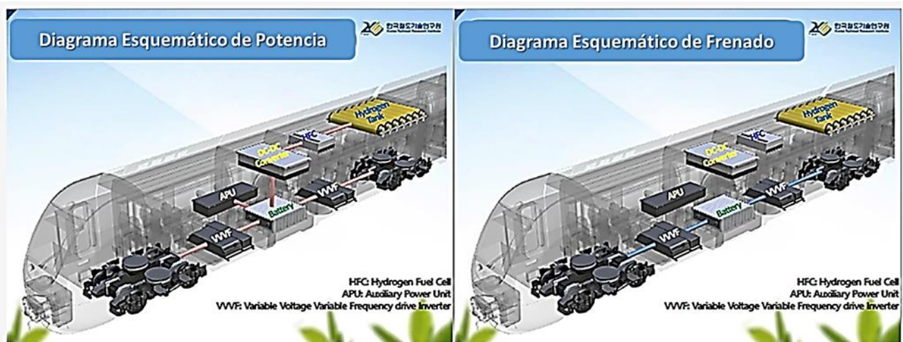
Fig. 114 – Sistema de potencia y sistema de frenado regenerativo – Fuente: Chang S., 2019
