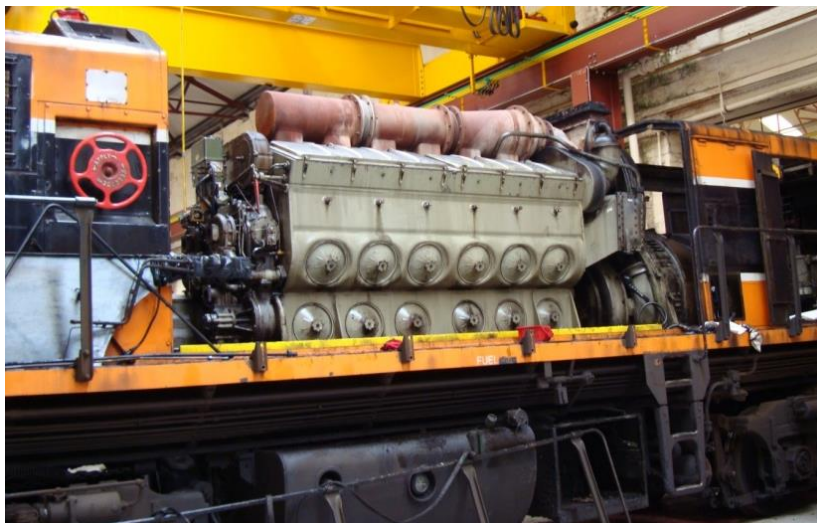
Fig. 104 – Planta motriz y generadora de la GT22 – Fuente: https://es.wikipedia.org/wiki/EMD_645
