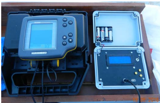
Figura 3. Vista del dispositivo (a) Unidad de Procesamiento y Display Ecosonda; (b) Adquisidor, GPS; IO y Unidad de Procesamiento
