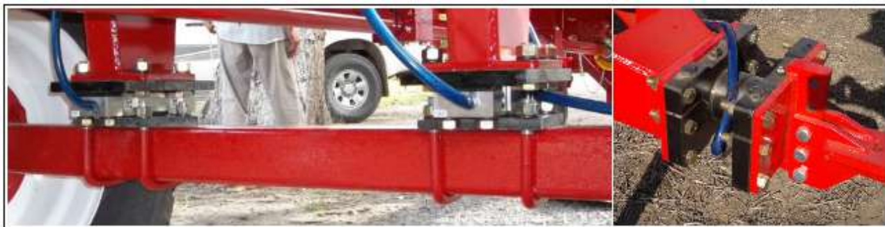
Figura 49: Ejemplo de celdas de carga colocadas en el eje y enganche de una fertilizadora.
