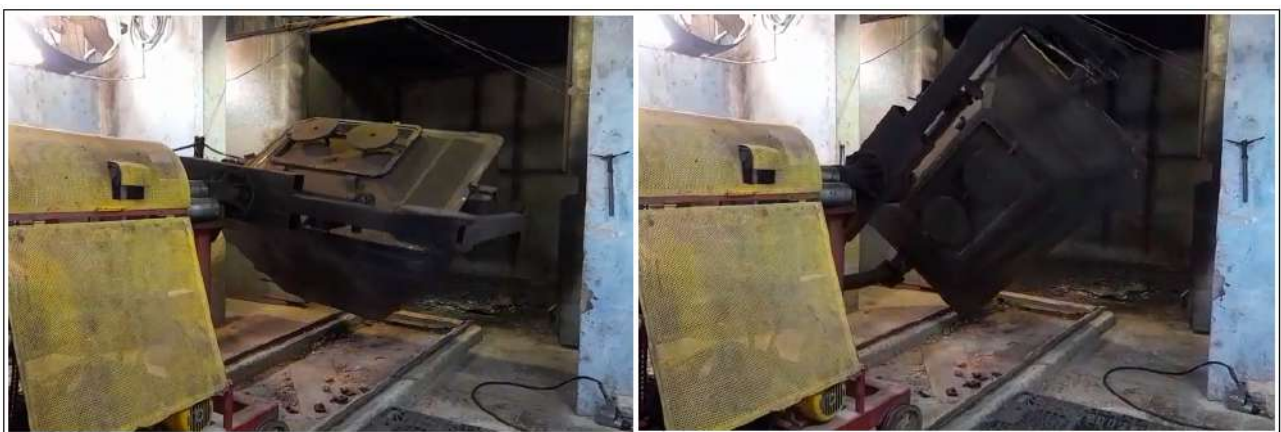
Figura 10: Horno para rotomoldeo. Se observa la maquina que rota el molde (afuera de la cabina, que se ve detrás).
