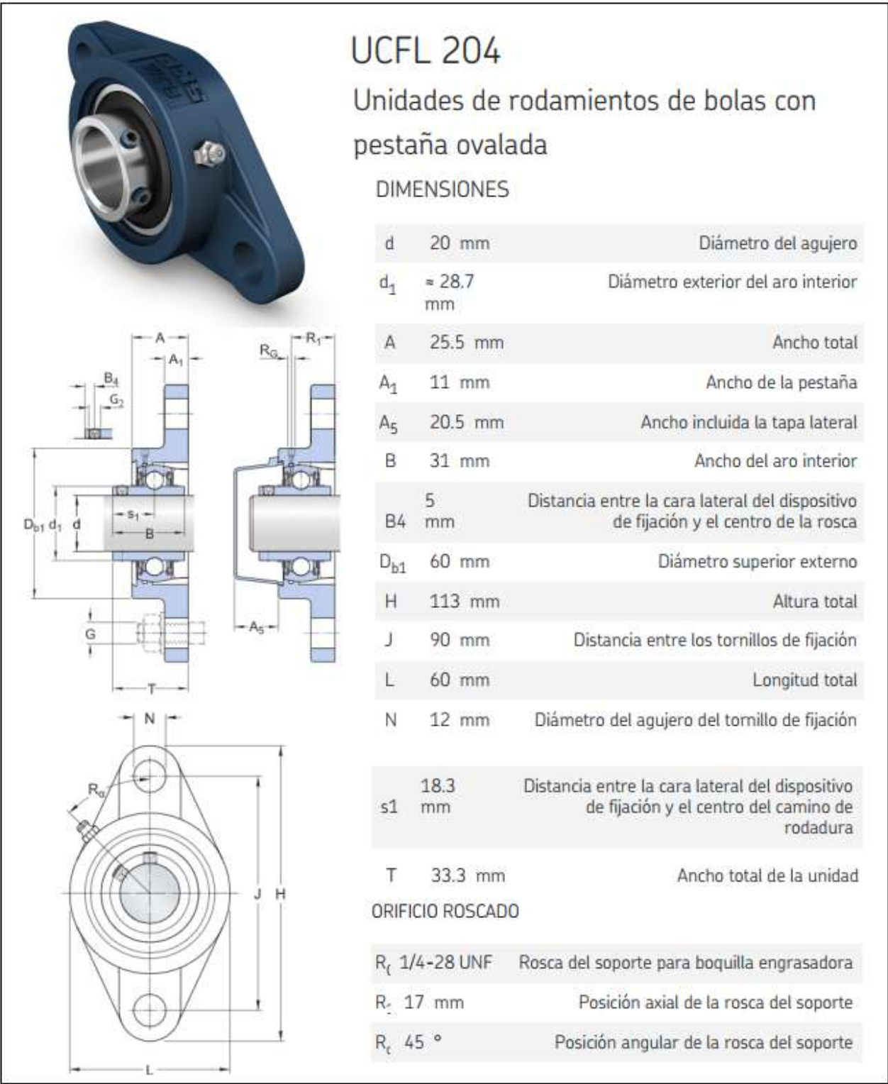
Figura 78: Selección de rodamiento y soporte para rodillos superiores
