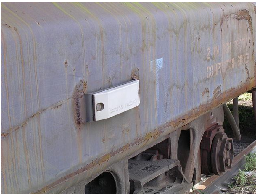
Figura 6: TAG Industrial RFID colocado en un vagón de carga. Fuente: Wikipedia
