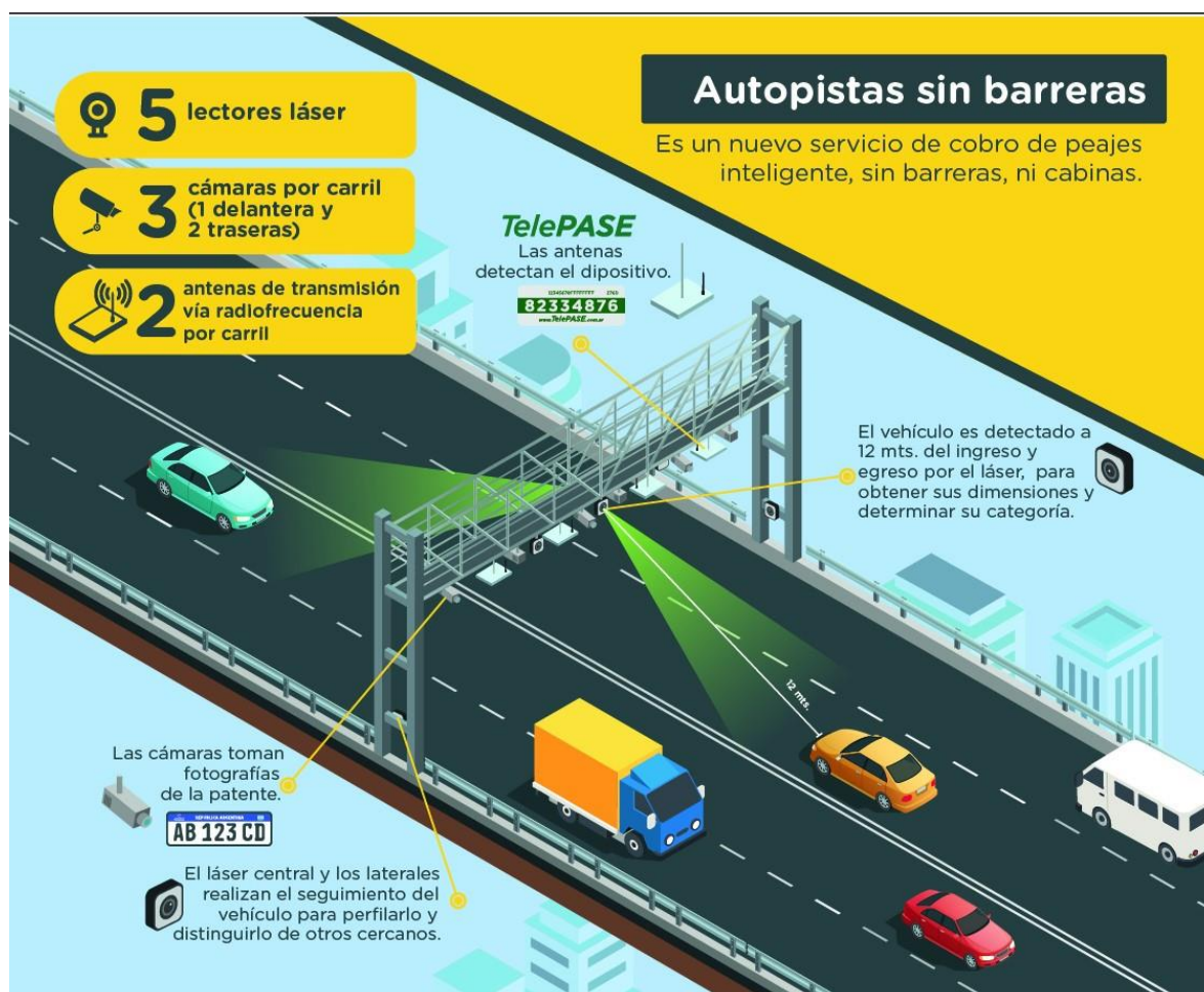
Figura 9: Componentes del sistema de peaje de Buenos Aires. Fuente: buenosaires.gob.ar
