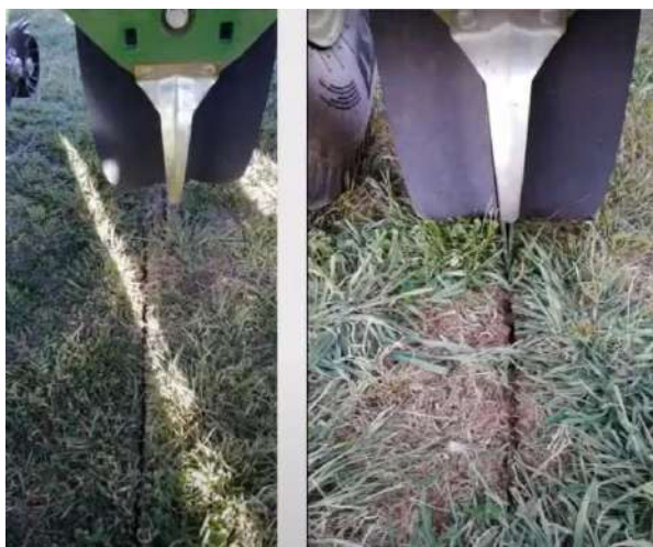
Figura 2-41: Izquierda: Desalineación de la cuchilla de docente con el doble disco. Derecha: Buena alineación
