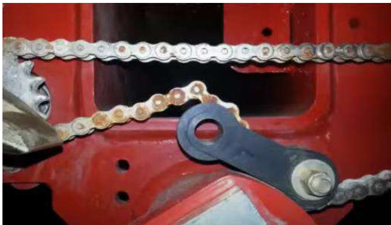
Figura 2-46: Cadena rígida, provoca saltos de velocidades en dosificación.
