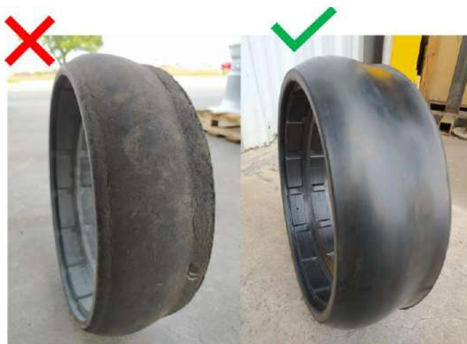
Figura 2-38: Comparación de estado en ruedas niveladoras de profundidad.
