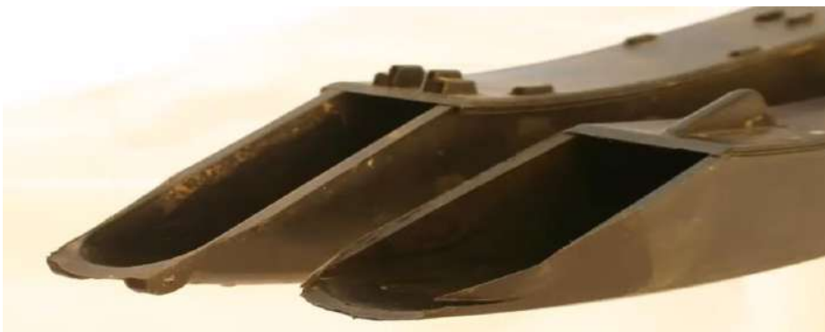
Figura 2-47: Rebarba generada en tubo de bajada producto de desgaste
