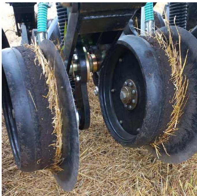
Figura 2-37: Rastrojo entre rueda niveladora y doble disco abresurcos
