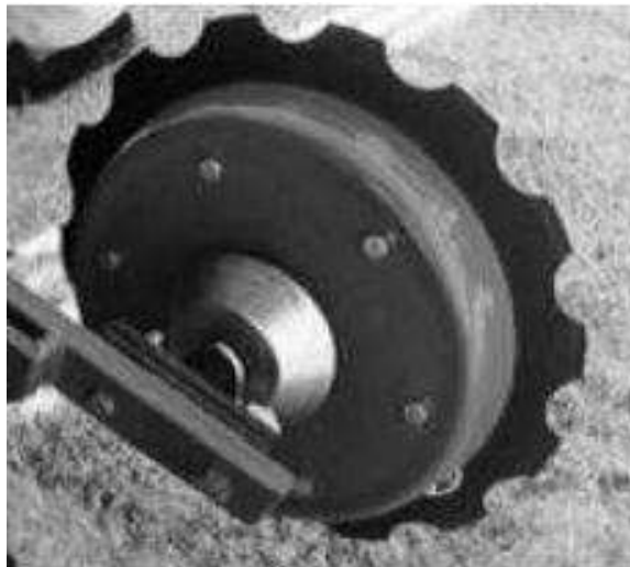
Figura 2-35: Rueda tapadora simple dentada con inclinación
