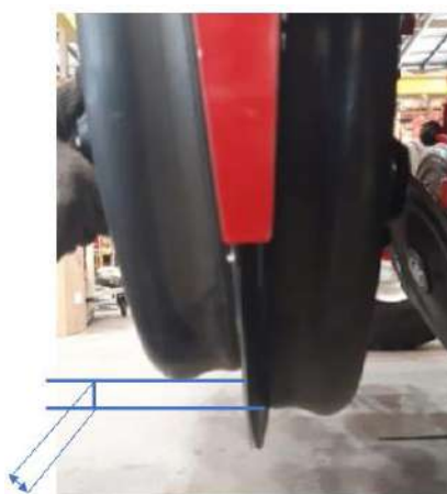
Figura 2-39: Desnivel de ambas ruedas producto de desgaste de balancín.
