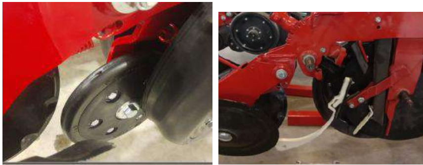
Figura 2-33: Contactadores de semilla
