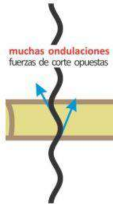
Figura 2-20: Representación esquemática de cuchilla de corte con muchas ondulaciones.
