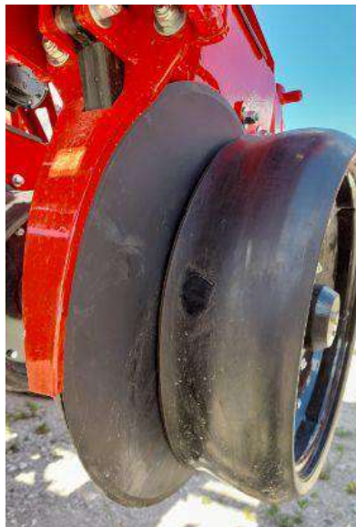
Figura 2-28: Cuchilla abresurcos bidisco.
