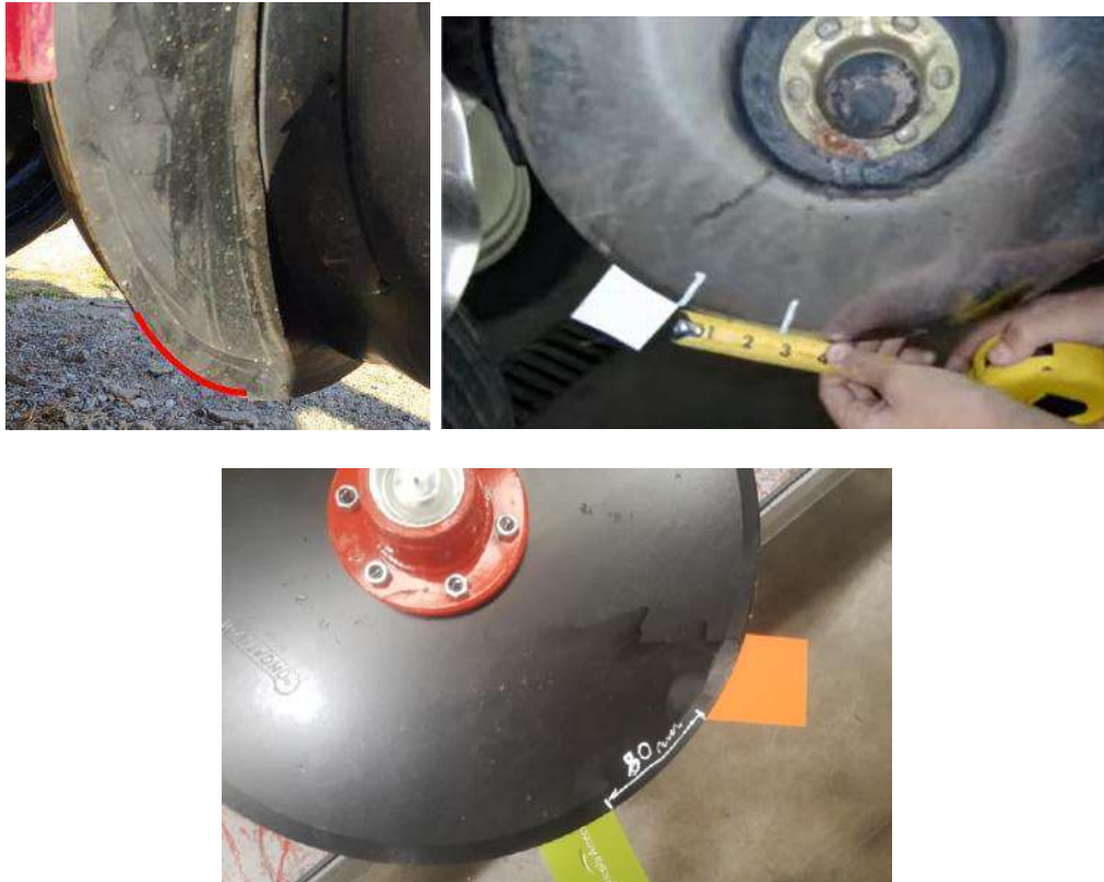
Figura 2-36: Medición de desgaste de doble disco abresurcos
