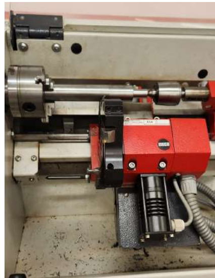
Figura 52: Montaje de la barra en el torno CONCEPT TURN 60
