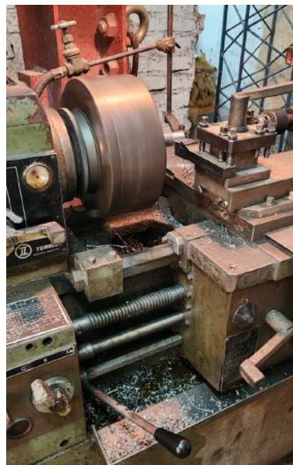
Figura 50: Torneado de la probeta en el torno paralelo del EIM
