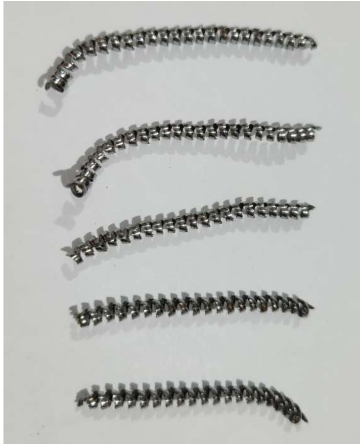
Figura 54: Viruta producto del desbaste grueso
