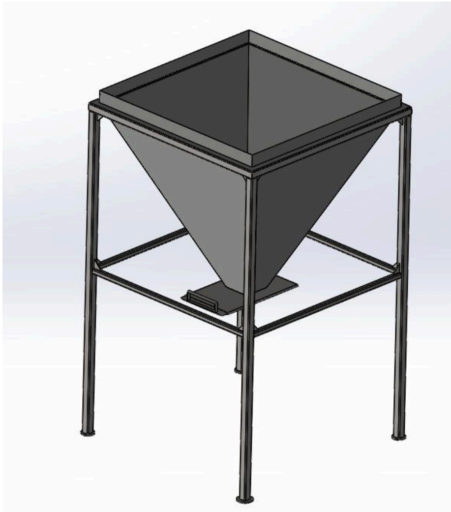
Figura 3-2: Conjunto tolva y estructura
