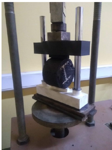
Figura N° 5 - Ensayo a tracción por compresión diametral. Fuente: presentación de clase de curso para Maestría vial - FCEIA - UNR.
