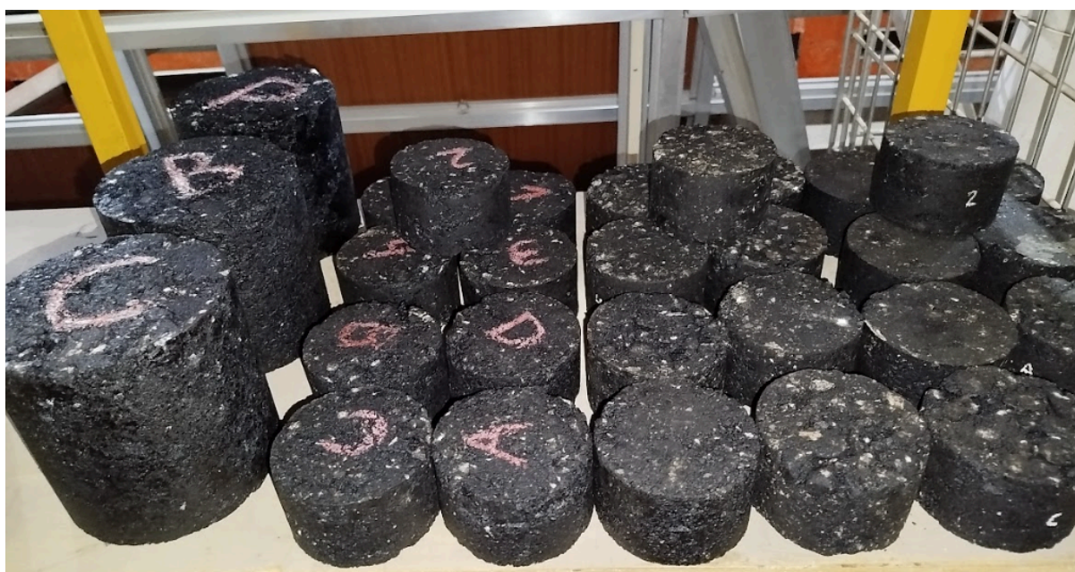
Figura N° 17 - Probetas tipo Marshall y giratorias fabricadas. Fuente: elaboración propia
