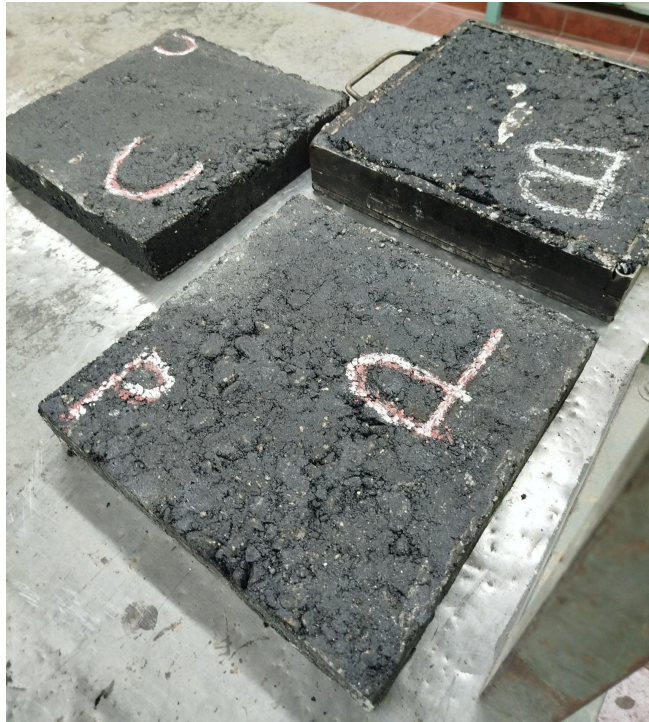
Figura N° 18 - Probetas para ensayo "WTT". Fuente: elaboración propia.
