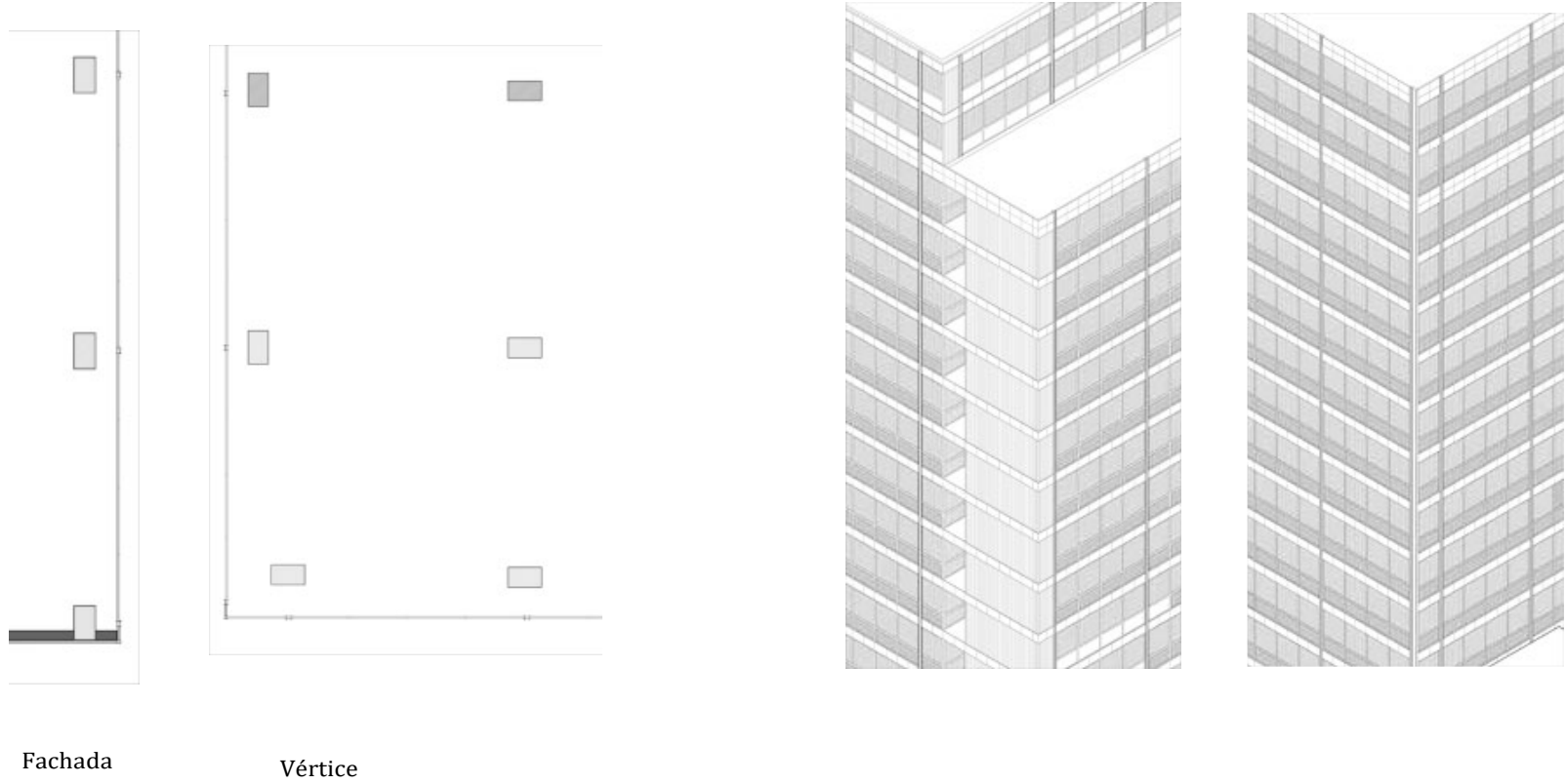
Relación estructura portante y cerramiento
