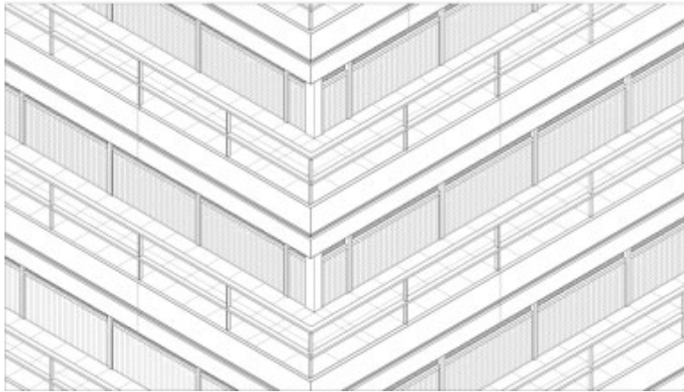
Elementos: balcón, baranda, piso flotante, antepecho, carpintería
