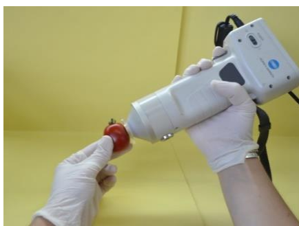
Figura 4: medición de los parámetros L (porcentaje de reflectancia), a y b (absorbancias) usando un cromámetro
