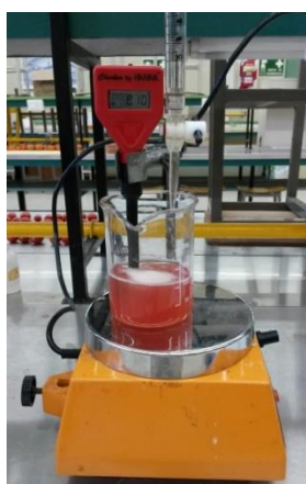
Figura 5: bureta, pHmetro, agitador y jugo disuelto en agua para medición de acidez titulable
