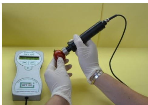
Figura 3: medición de firmeza usando un durómetro
