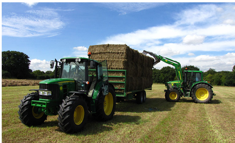
Figura 1.14: Tractor con cargadora frontal cargando un remolque, tirado por otro tractor [56]
