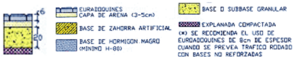
Figura 2.3.8: Perfil transversal de paseo peatonal / vehicular.
