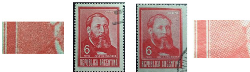
Fig. 7. A la izq., sello huecogravado (Y.T. 779) y a la derecha, centro impreso en hueco offset (Y.T. 779b) Nótese la mayor gradación de claroscuros lograda en el primer caso, las líneas del marco tienen aspecto aserrado, trama cuadriculada a 45°, los medios tonos se logran con cuadrados del mismo tamaño con más o menos tinta, mientras que el offset con puntos circulares de distinto tamaño y los trazos de las líneas están perfectamente definidos. (1962-1965). Crédito fotográfico: la autora
