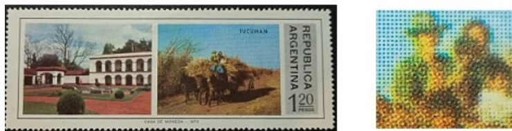
Fig. Sello policromo impreso offset, con calidad fotográfica (Y.T. 1002). En la imagen ampliada puede verse claramente que el azul del cielo presenta un tramado paralelo a los bordes del marco con puntos circulares de distinto tamaño para dar la gradación de tonos. Mientras que los distintos colores de las personas están armados combinando tramados de CMYK con variación de ángulos (1975). Crédito fotográfico: la autora.
