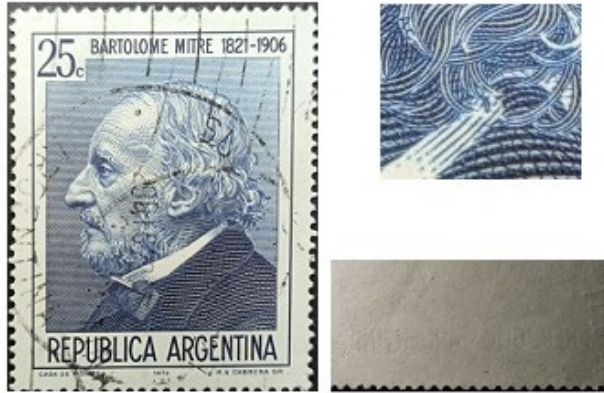
Fig. 10. Sello grabado en talla dulce (Y.T.930). Por ser un sistema de impresión bajo relieve, el papel debe deformarse mediante presión, para hundirse en los surcos de la matriz grabada que contienen alojada la tinta oleosa de secado rápido que quedará adherida a él. En la ampliación, pueden notarse las crestas brillantes de tinta y arriba a la izq. El gesto barroco del grabador al esconder sus iniciales en la imagen. El dorso ampliado muestra el papel hundido hacia la cara anterior (1972). Crédito fotográfico: la autora.
