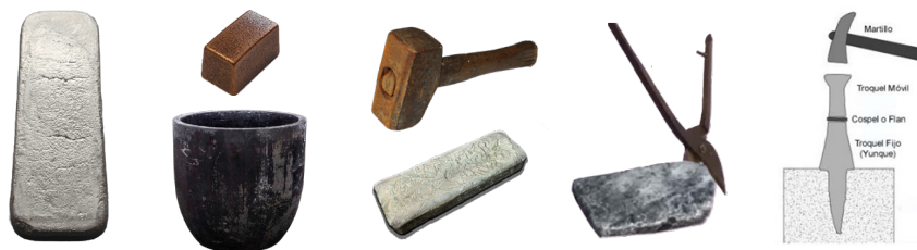
Fig. 5: materiales y herramientas utilizados en las cecas de las colonias de América para realizar la acuñación a martillo. Partiendo de lingotes de plata ley 0,99 hasta la obtención de macuquinas de ley inferior.
