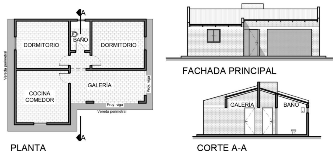
Figura 96. Esquema tipo de la vivienda construida en la zona de Paso Maroma
