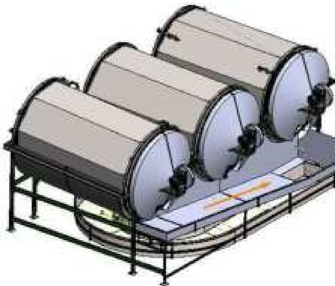
Figura 3-9: Flujo de ramas en rampa de descarga. [Elaboración propia]
