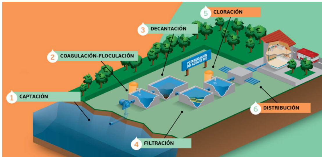
Figura N°1 - Esquema sintético del proceso de potabilización. 1
