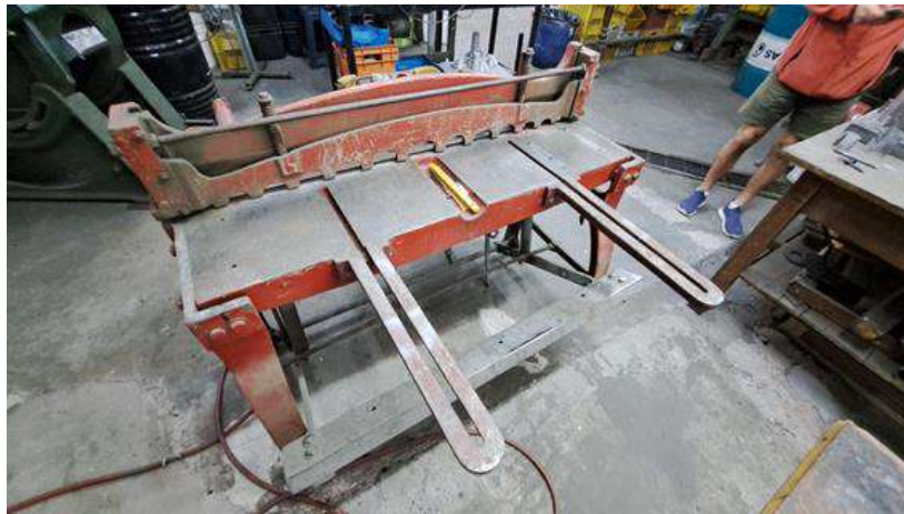
Figura 2-1: Guillotina de corte
