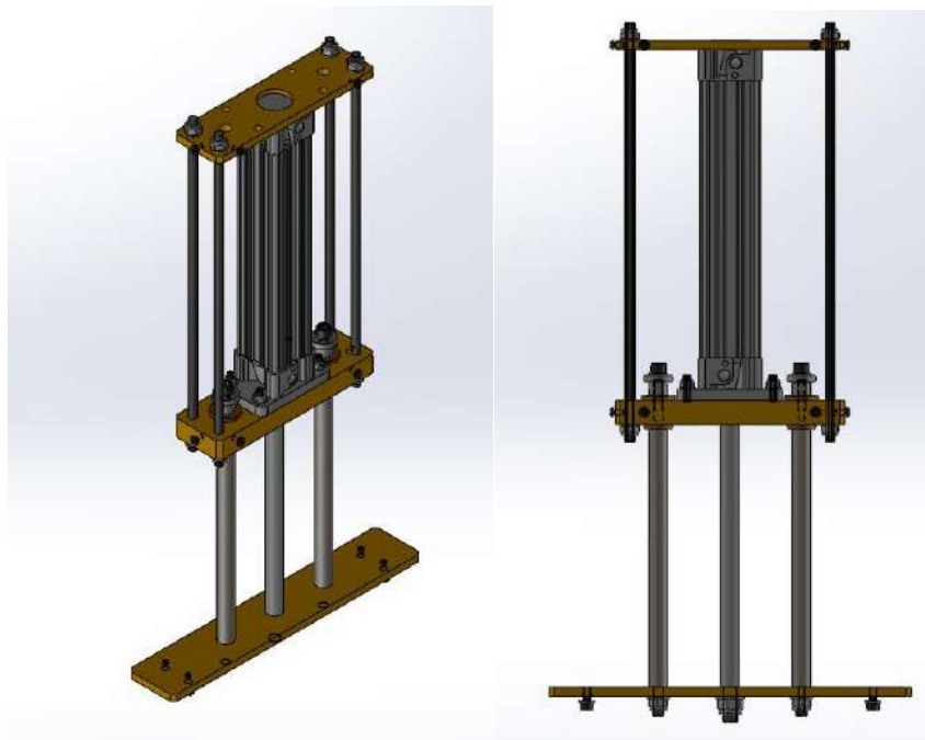
Figura 4-4: Idea básica minupulador de chapas
