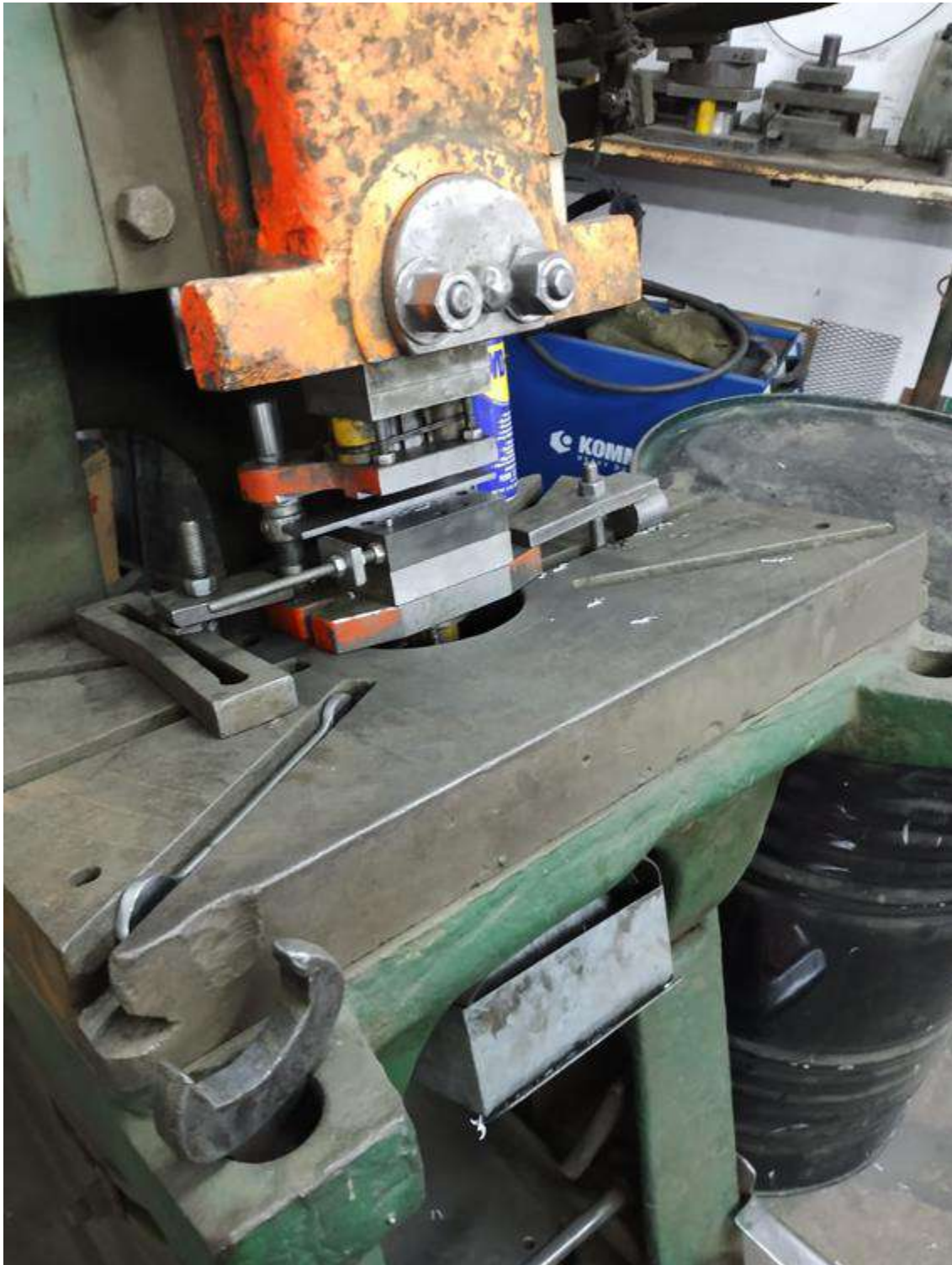
Figura 2-6: Balancin para estampado de chapas
