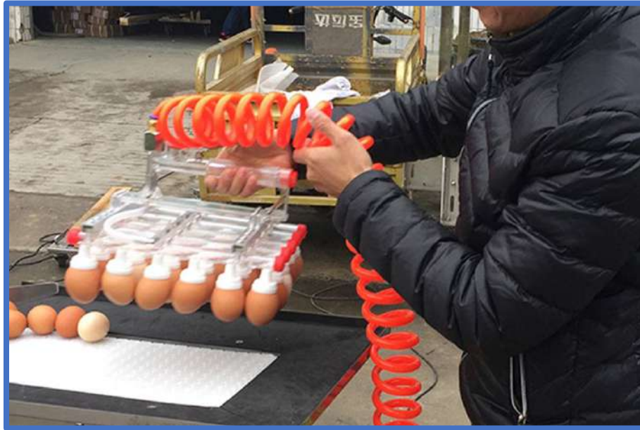
Figura 2-1: "Manipulador Neumático de Huevos" Bibliografía [4]
