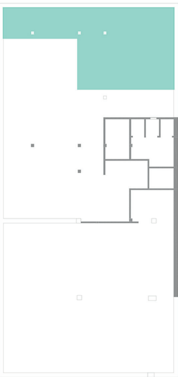
MUROS A CONSTRUIR PRIMERA PLANTA ESC. 1:250
