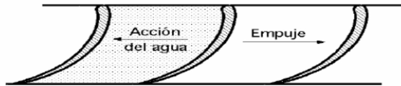
Fig. 3.6. Turbina de Reacción.
