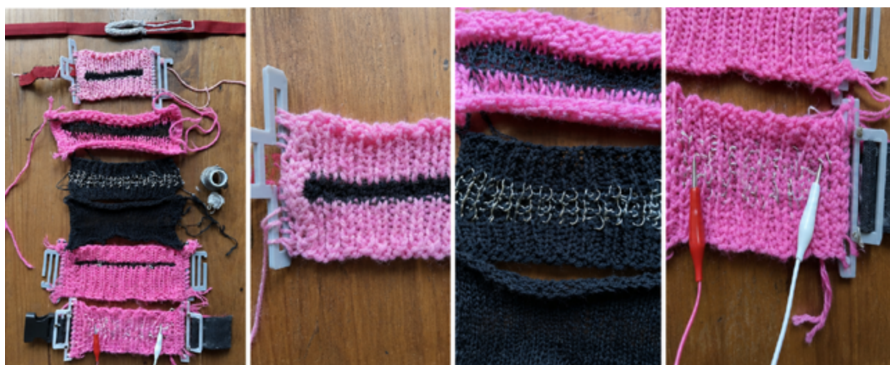
Fig. 6: Muestras de los cinturones tejidos de lana resistiva a lo largo de las iteraciones.
