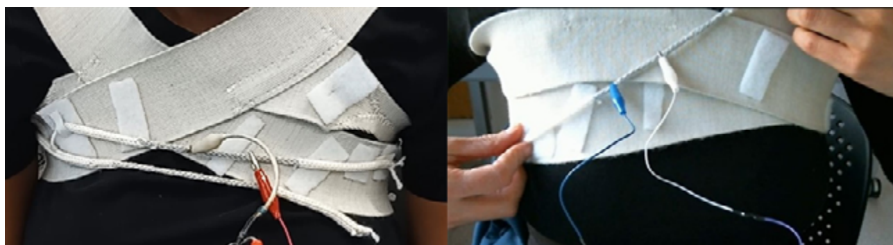
Fig. 7: Prototipo de una versión alternativa para una correa extensible en forma de arnés.
