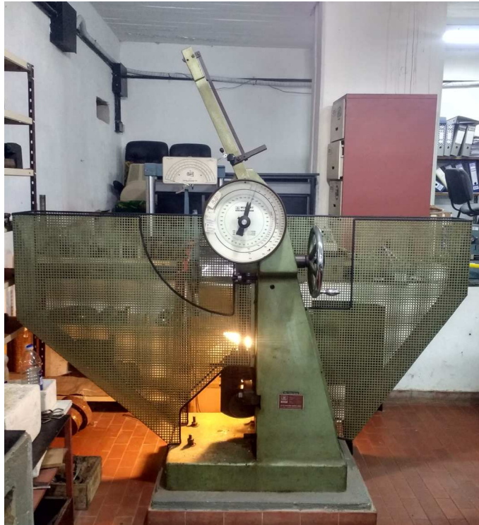
Figura 3.10: Máquina de ensayo de Charpy, del Laboratorio de Ensayos Mecánicos (DAT).
