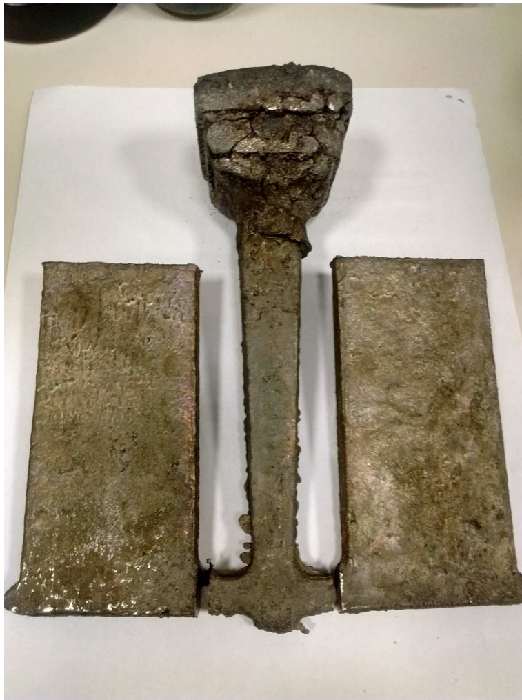
Figura 3.5: Lingotes obtenidos de acero Fe-18Mn-2Si-2Al (Generación 2), utilizando un molde metálico. Entre los lingotes se observa el material solidificado en el canal de colada y el embudo.
