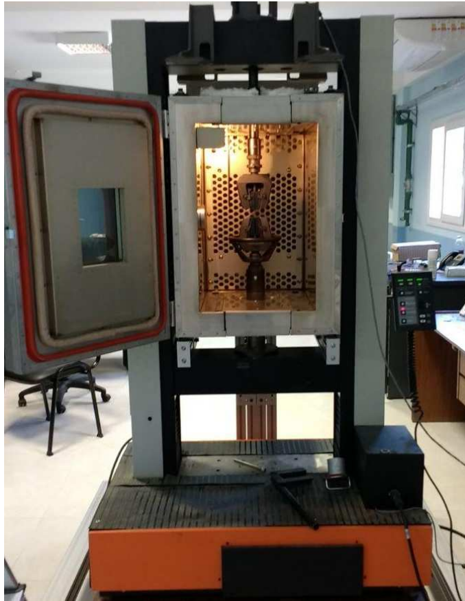
Figura 3.8: Instron 3382, con cámara térmica para control de temperatura entre -80 y 250^{\circ}\text{C}
