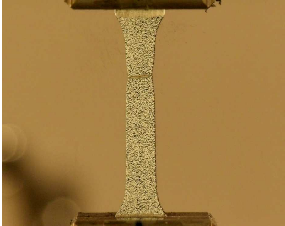
Figura A.2: Probeta de tracción fracturada con un patrón “speckle” impreso en su superficie.
