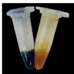
Figura 2. Blue-Carba Test en tubos tipo Eppendorf. A la izquierda, control negativo (azul); a la derecha, prueba positiva (amarillo).
