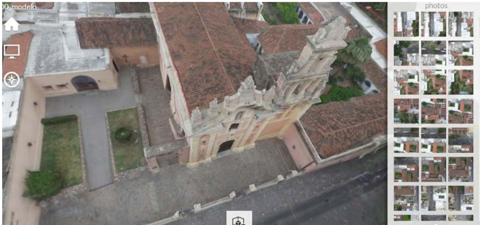
Visualización en ReCapPhoto del modelo 3D del convento de las Carmelitas descalzas, Córdoba. Fotogrametría con dron. Natalia Magris.
