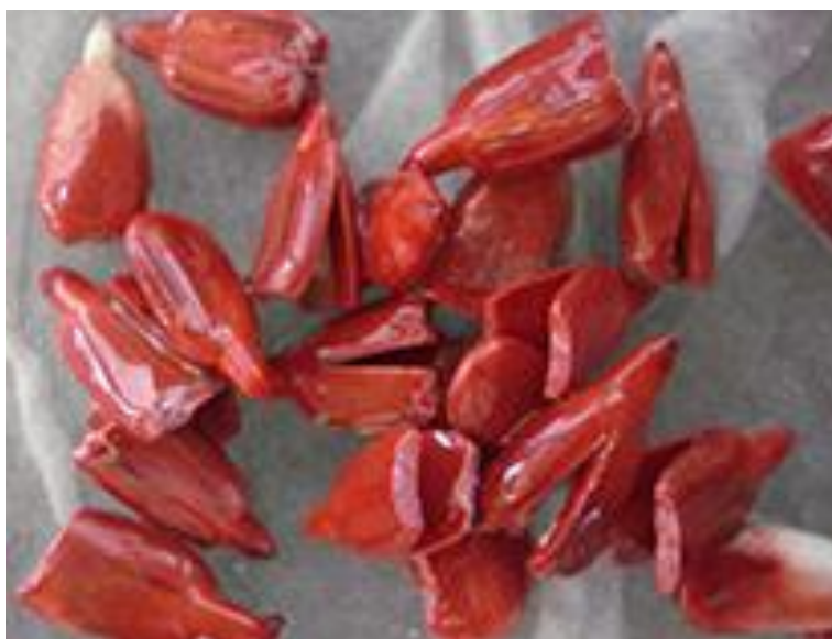
Fig. 11. Semillas de girasol Nusol 4510 CLAO sometidas a prueba topográfica de tetrazolio.
