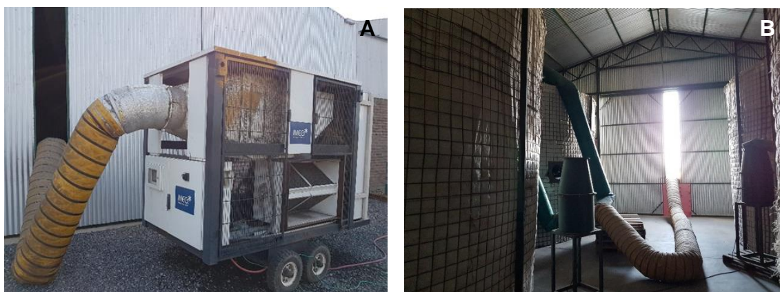
Fig. 7. A) Equipo de refrigeración Imeg modelo #52GA-200, empleado para insuflar aire frío y seco (10 °C - 50 %HR) a los acuenios de girasol en los tratamientos T1 y T2. B) Detalle de la manga de insuflado de aire frío y seco en los tratamientos T1 y T2.
