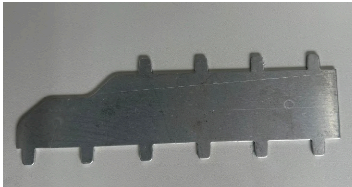
Figura 3-8: Álabes a ensayar de aluminio 5052 H32
