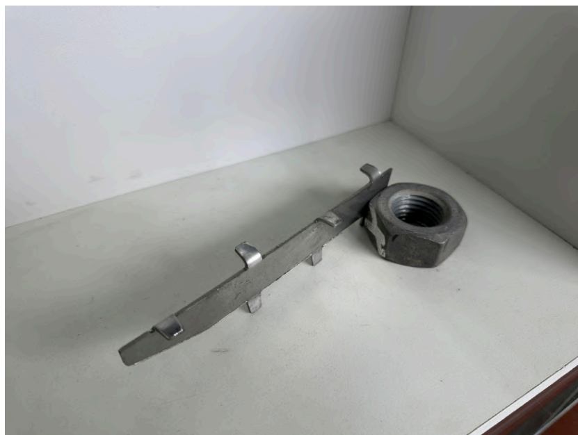
Figura 3-15: Álabe con sus pestañas de un lado plegadas
