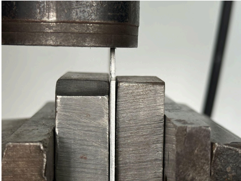
Figura 3-10: Pestaña perpendicular a la superficie del punzón
