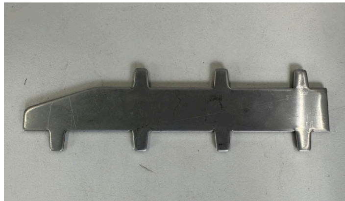
Figura 3-7: Álabes a ensayar de acero inoxidable AISI 304
