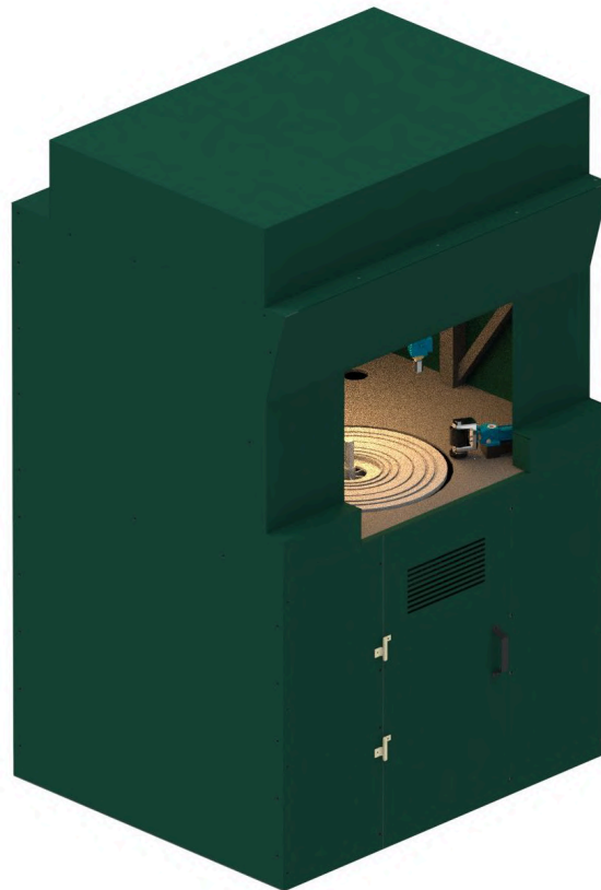
Figura 4-35 : Diseño final de la máquina, con sus cerramientos
