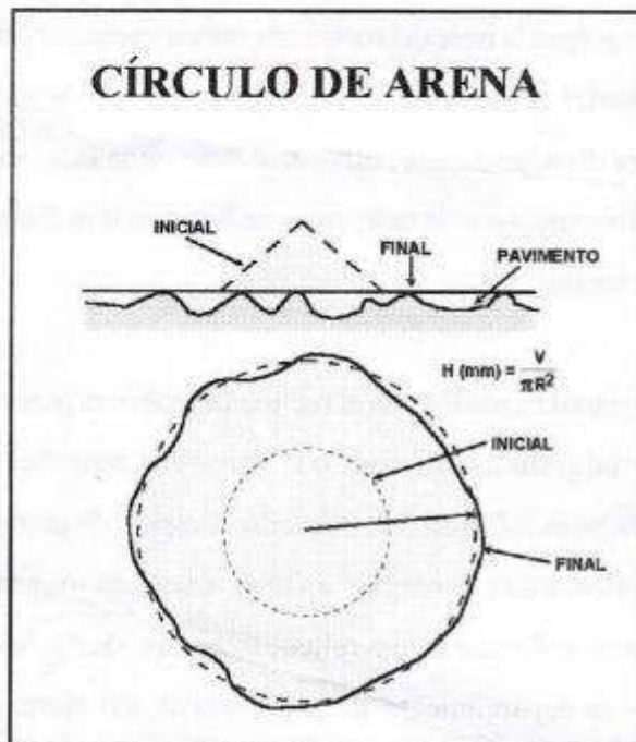
FIGURA 4. Esquema del ensayo del círculo de arena
