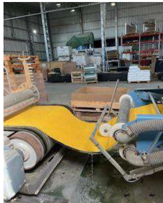
Fig.24: Camino al enfriamiento de la lámina Preformada.
