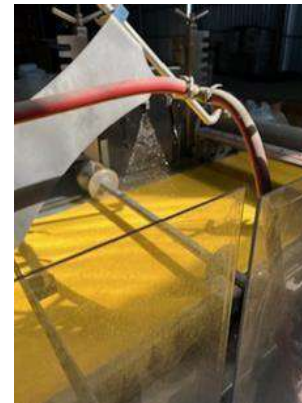
Fig.25: Enfriamiento de la lámina Preformada.
