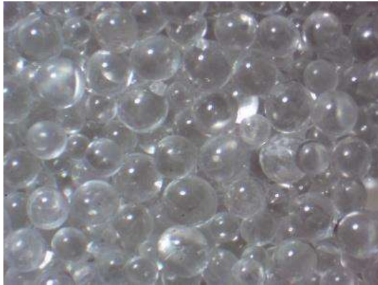
Fig.29: Microesferas composición del Preformado izq.
