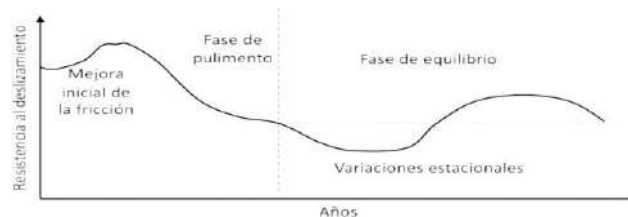
Figura 2. Evolución de la Fricción (Fuente: Lanamme: Laboratorio Nacional de Materiales y Estructuras, Universidad Costa Rica. Extraído del Departamento de Geotécnica de la Facultad de Ingeniería de Uruguay (Udelar)-Instituto de Estructuras y Transporte: Taller:” Evaluación de Pavimentos-2023”.
