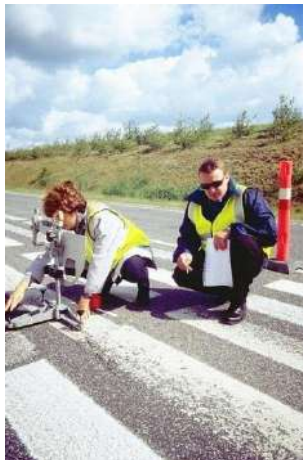
Figura 39.- Medición con Péndulo Británico en una carretera (Fuente: NMF Nordisk Mode for Forbedret. Extraído de Documentos de Nordic Meeting for improved road equipment-2011: Performance of road markings and road surfaces).
