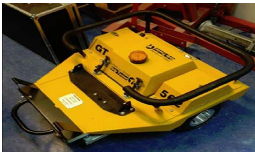
Figura11: Imagen del Equipo Grip Tester (Facultad de Ingeniería)
