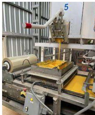
Fig.20: Cae la pintura a la batea, que contiene Microesferas de composición. Pasa el nylon especial que se encuentra en rodillo a la izquierda por debajo, para servir como base a la pintura y formar la plancha.
