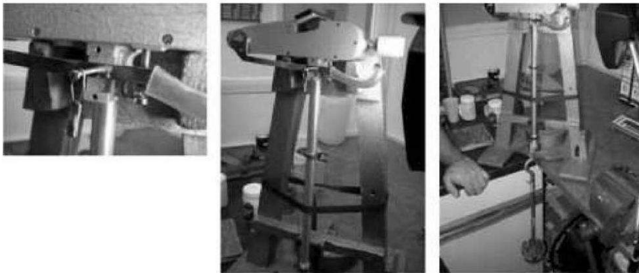
Figura A.3 – Fotografías mostrando la calibración de la tensión del muelle
