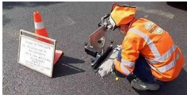
Figura 9.- Medición con Péndulo Británico (Fuente: Intecpavsac: Inversión y Tecnologías de Pavimentos SAC- Empresa de San Martín de Porres-Lima Perú.Extraído “Ensayo de Coeficiente de Resistencia al deslizamiento en el Pavimento con Péndulo Inglés”).
