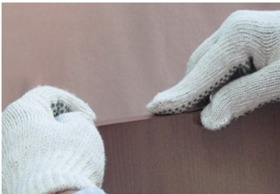
Figura 4: Proceso de pegado de tapacantos
