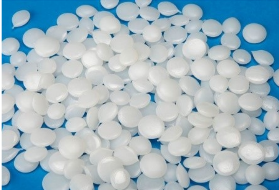
Figura 5: Pellets de adhesivo hot melt
