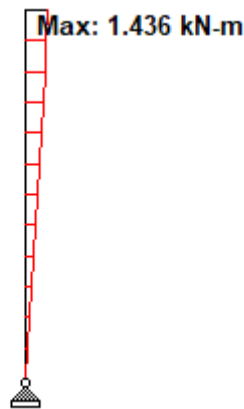
Imagen 3.32. Esfuerzo de momento flector según Programa de cálculo.
