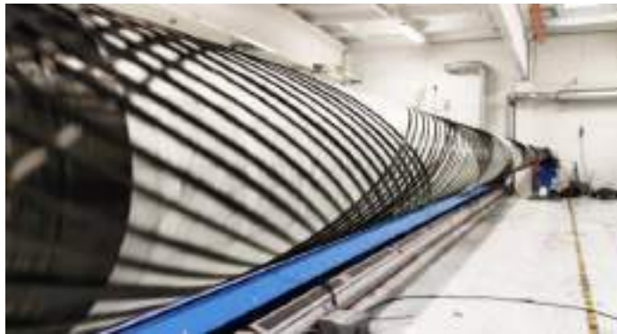
Imagen 1: Tubo laminado por método de filament winding
