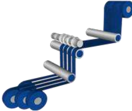
Figura 2-2: Corte del tipo rewind slitting
