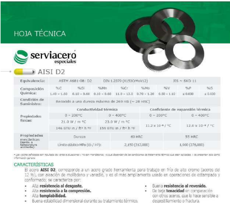
Figura 4-14: Características del acero AISI D2.
