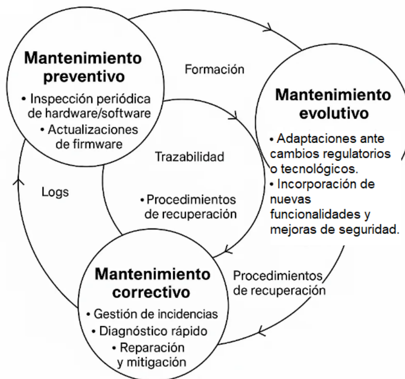
Figura 282: Ciclo de vida del mantenimiento de sistemas ADS-B SDR: preventivo, correctivo y evolutivo.
