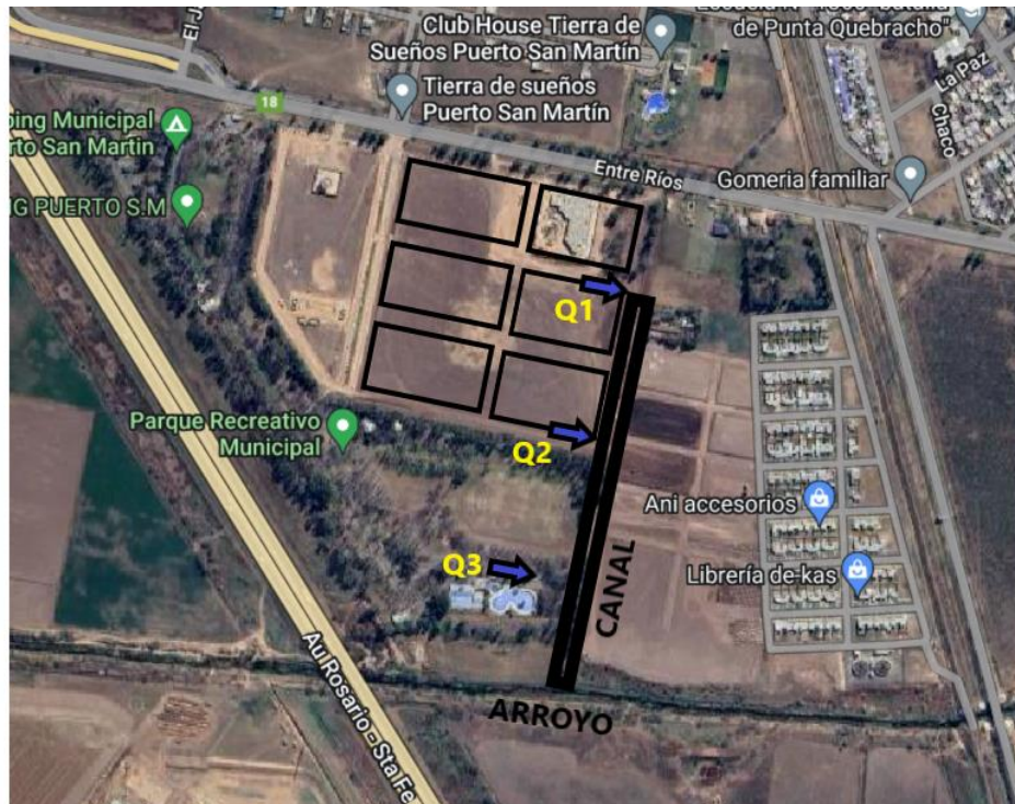
Ilustración 27- Esquema de ingreso de caudales a lo largo del desarrollo del canal
