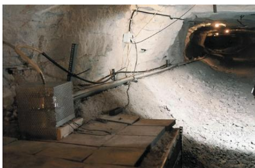
Figura 2.6: El inclinómetro de tubo de agua WTH20 estuvo instalado durante 10 años en el laboratorio subterráneo para geodinámica en Walferdange (WULG). Representa uno de los inclinómetros de mayor resolución instalados en el laboratorio.
