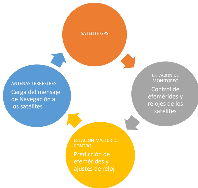
Figura 4.14: Esquema de funcionamiento del segmento de control en el sistema GPS.
