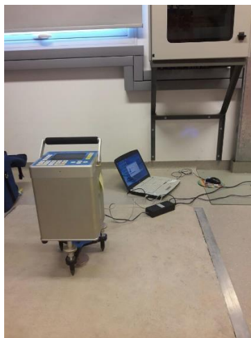
Figura 2.7: Gravímetro de resorte Scintrex CG-5 recolectando datos, sobre pilar de concreto en el Laboratorio de Gravedad del Observatorio AGGO.
