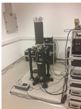
Figura 2.9: Gravímetro absoluto FG5-227. Observatorio AGGO.
