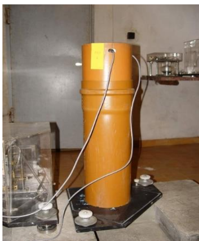
Figura 2.5: Inclinómetro con péndulo vertical instalado en el observatorio subterráneo de geodinámica URSOIU (Rumania).
