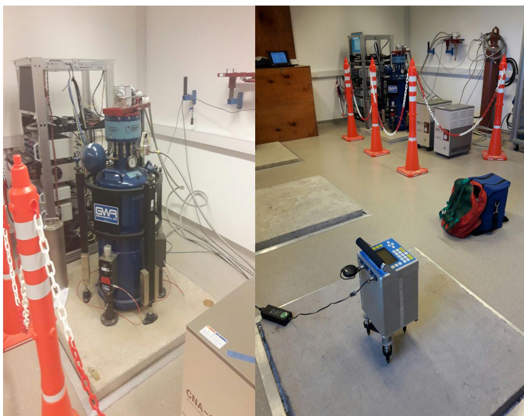
Figura 3.2: Izq.: Gravímetro Superconductor situado sobre pilar de concreto en el laboratorio de gravedad de AGGO. Der.: Gravímetro Scintrex CG-5 registrando mediciones co-localizadas en AGGO.
