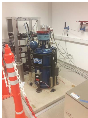
Figura 2.8: Gravímetro Superconductor SG038 instalado en AGGO.
