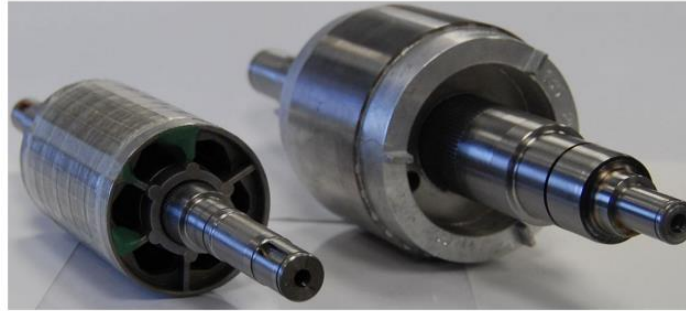
Figura 1-2: Diferencia de tamaño entre un servomotor (izquierda) y un motor de inducción (derecha)
