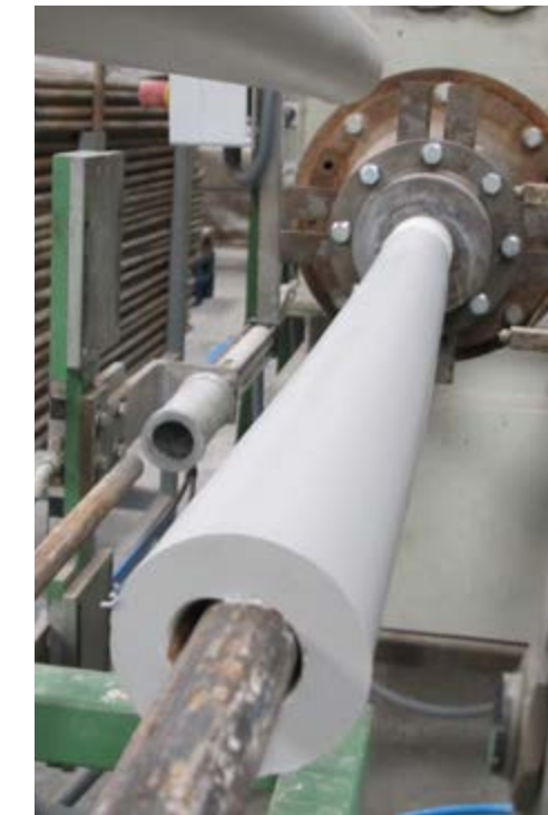
OAB, Biblioteca municipal en Vila Real, Castellón, Comunidad Valenciana, España (2009-2011). Elaboración cortina cerámica de fachada, en colaboración con BUTEC. Foto Alberto Peñin
