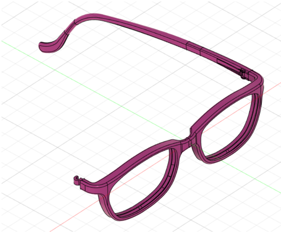
Fig.1 Modelo base de montura diseñado para moldeo por inyección.
