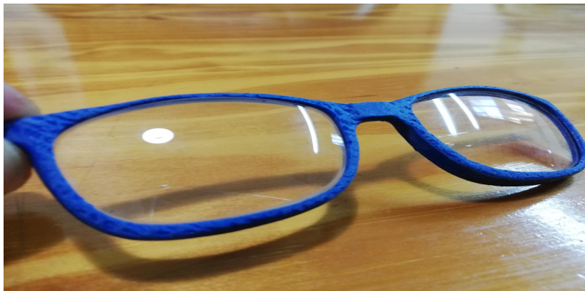
Fig 4. Prototipo impreso en FDM para comprobar anclaje de las lentes y dimensiones generales de la montura.
