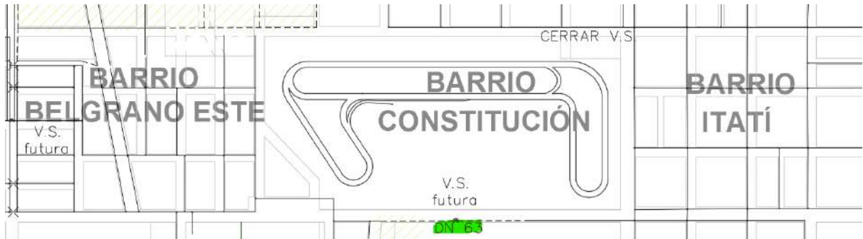
Ilustración 29: Nueva Tubería PEAD DN 63 B° Constitución
