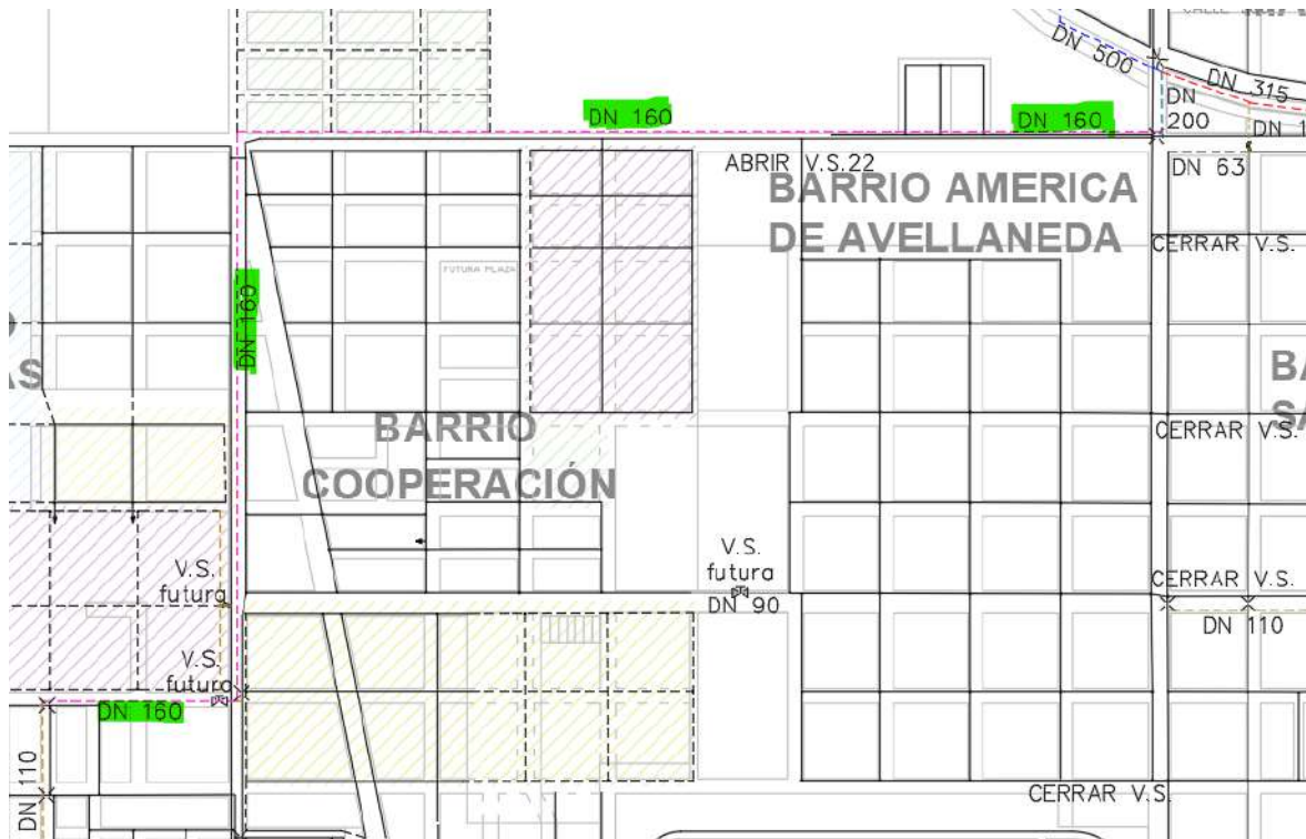
Ilustración 27: Nueva tubería PEAD barrios Oeste
