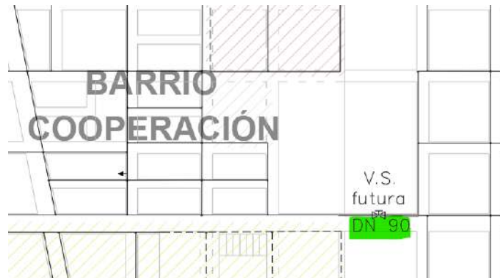
Ilustración 28: Nueva tubería PEAD DN 90 Barrio Cooperación
