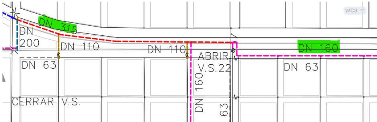
Ilustración 26: Nueva tubería PAD DN315 Barrios Centro
