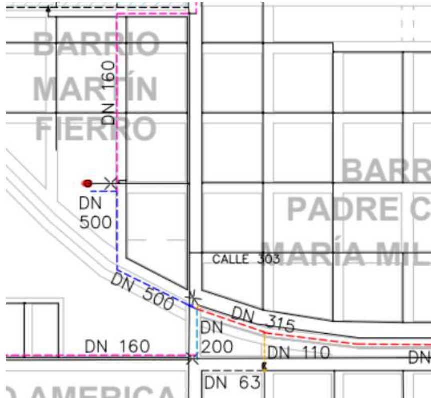
Ilustración 24: Nuevas tuberías en sector EBAP MF
