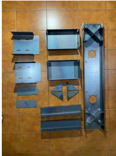
Figura 104: Chapas cortadas y plegadas[Propia].
