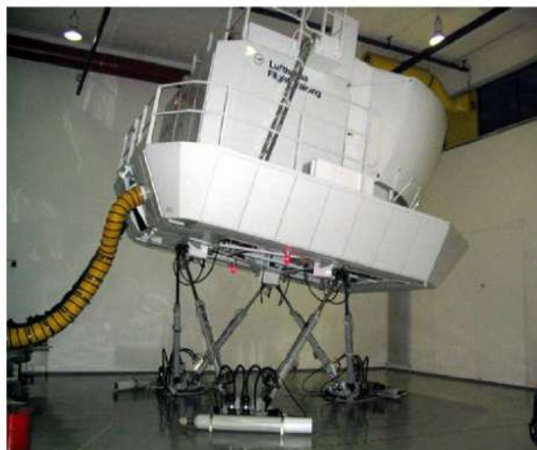
Figura 3: Simulador de vuelo Lufthansa basado en plataforma de Stewart [[3]]
